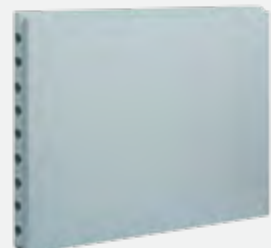
בלוק איזולציה עמיד מים Green Bond: בלוק אשבונד עמיד מים 6 ס"מ בשילוב שכבת בידוד ורדיד אלומיניום לבניית קירות איזולציה בחדרים רטובים
